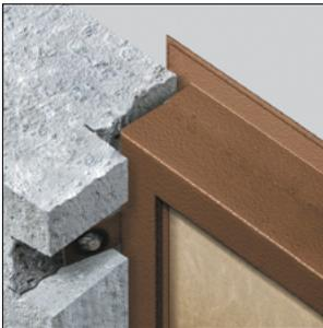
Вырубка четверти под раму и под монтажную пластину\*\*
