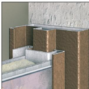
Сплошной противовзломный лабиринт
