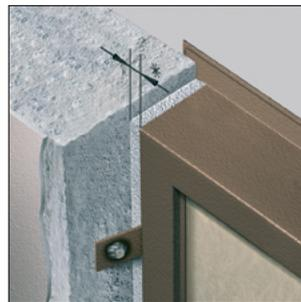
Дверной блок в проёме, наличниками внакладку на стену, монтажный зазор снаружи полностью перекрывается наличником рамы. **B-1**
