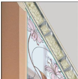
Контурный заливной витраж на зеркале (толщина 6 мм)
