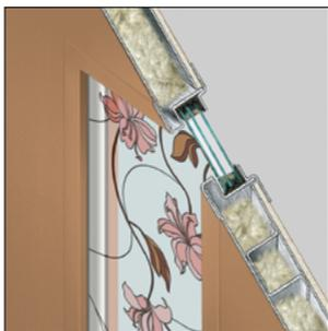
Контурный заливной витраж на двухкамерном стеклопакете\* (толщина 32 мм)
