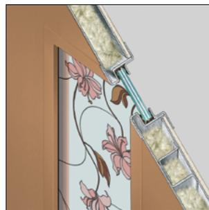
Контурный заливной витраж на бронестекле\* (толщина 17,5 мм)
